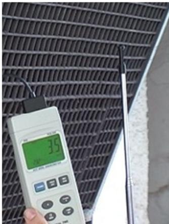
Flussimetro PCE-009 mentre effettua una misura all'uscita di un estrattore di fumo
