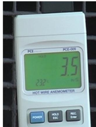
Vista del display del flussimetro PCE-009 dopo una misura.
