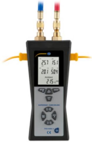
Le misure del manometro differenziale vengono effettuate tramite i collegamenti corrispondenti. Ai lati ci sono le connessioni per le termocoppie (connettori gialli). Con la dovuta impostazione determina anche la differenza di temperatura. Il sensore NTC installato internamente misura la temperatura ambiente. I tubi di pressione sono attaccati al lato superiore. Attraverso quei connettori si può determinare la pressione differenziale.
