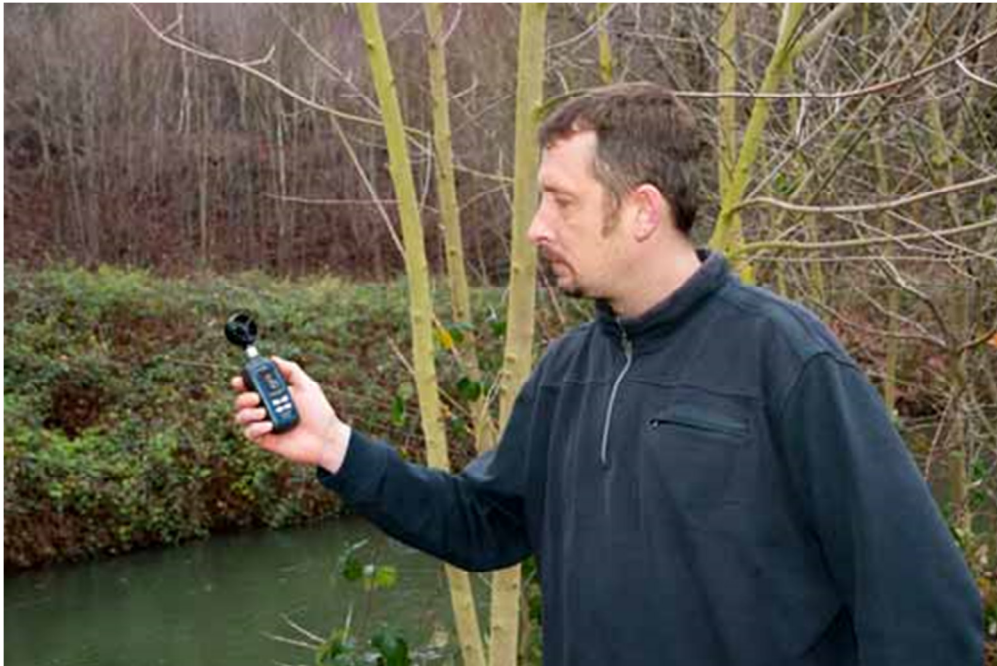
Utilizzo all'esterno del mini-anemometro PCE-MAM 2
