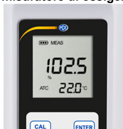
Il misuratore di ossigeno disciolto PCE-WO2 10 con display digitale
