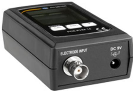
Collegamento BNC per l'elettrodo e collegamento per l'alimentatore del misuratore di pH
