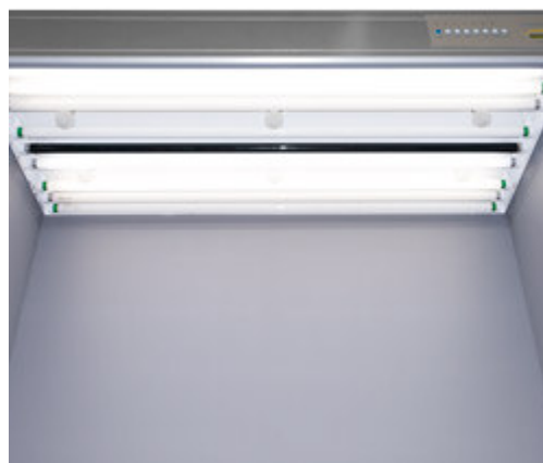
Interno della cabina luce con sorgenti luminose
