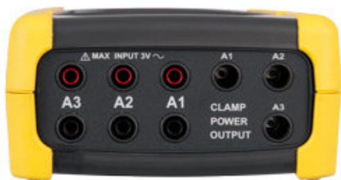
Qui può vedere i vari connettori dell'analizzatore di potenza e armoniche PCE-PA 8300
