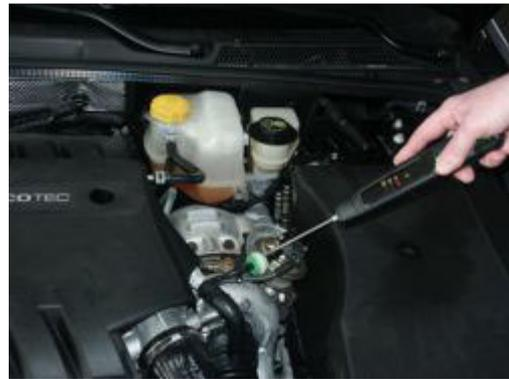
Uso dello stetoscopio elettronico PCE-S 41 mentre verifica un turbocompressore
