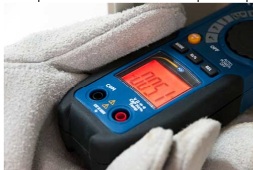
Misura della tensione con la pinza amperometrica a ganasce aperte
