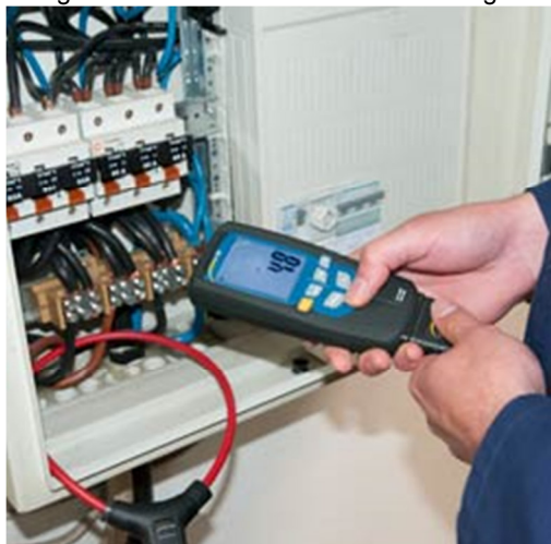
Misura della frequenza con la pinza amperometrica flessibile
