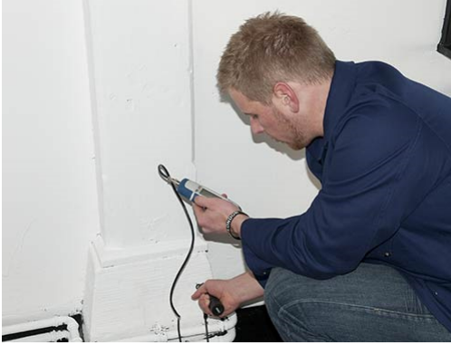
Utilizzo del rilevatore di umidità
