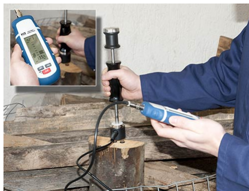
Il rilevatore di umidità mentre misura con l'elettrodo a martello
