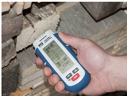
Il rilevatore di umidità mentre misura con le sonde interne
