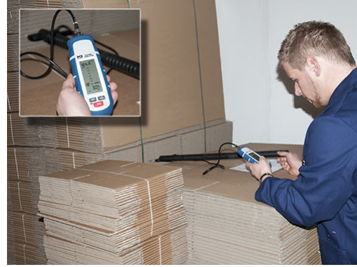
Uso del rilevatore di umidità
