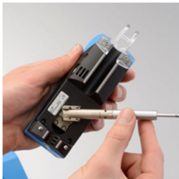
Tastatore girevole a 90° del rugosimetro Hommel-Etamic W10
