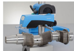
Il rugosimetro Hommel-Etamic W10 effettua una misura trasversale veloce
