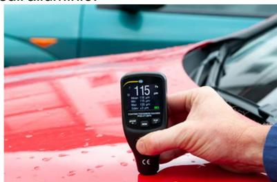
Gli standard di calibrazione inclusi nella spedizione consentono di regolare lo spessimetro in qualsiasi momento. Per fare ciò, posizionare uno standard di calibrazione su una piastra (Fe o NFe) e posizionare il dispositivo sullo standard di calibrazione. Assicurarsi che il dispositivo sia dritto e posizionato correttamente.
