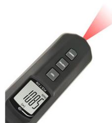
Il display del tachimetro ruota automaticamente di 180°, a seconda se la misura è con o senza contatto
