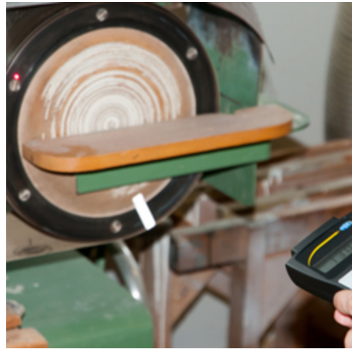
Misura ottica su levigatrice a nastro
