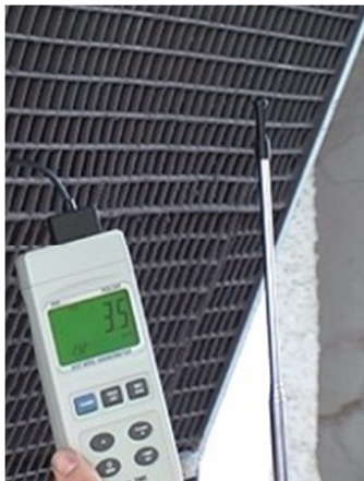
Termoanemometro PCE-009 mentre effettua una misura all'uscita di un estrattore di fumo
