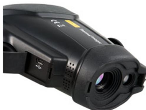
Proprio sopra il pulsante si trova l'interfaccia USB per collegare la termocamera a un PC
