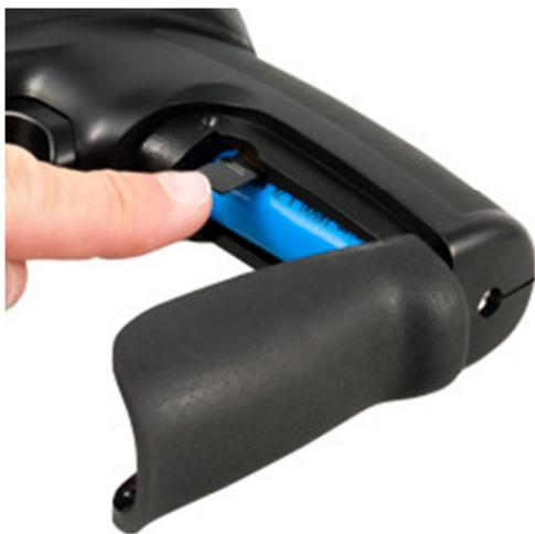
Nel vano batteria della termocamera si può inserire una scheda di memoria micro SD
