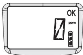
Il canale del sensore visualizza il valore corrente del gas monitorato e l'unità di misura. Il simbolo 'OK' lampeggia per indicare che l'apparecchio sta funzionando correttamente. Verificare il tipo di gas monitorato dall'apparecchio. Per ulteriori informazioni sulle letture dei picchi e dei TWA, vedere la sezione 2.4.
