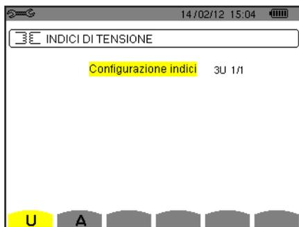
Figura 27: Lo schermo Indici di tensione nel menu Sensore e indici in caso di un montaggio **senza** neutro
