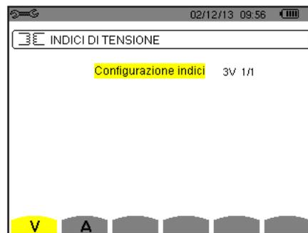
Figura 28: Lo schermo Indici di tensione nel menu Sensore e indici in caso di un montaggio **con** neutro
