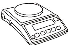
Quando la funzione *AUtotAr* si attiva, la bilancia manterrà automaticamente l'indicazione zero se il piatto di pesata è vuoto o premendo il tasto  $g \rightarrow T \leftarrow$ .
