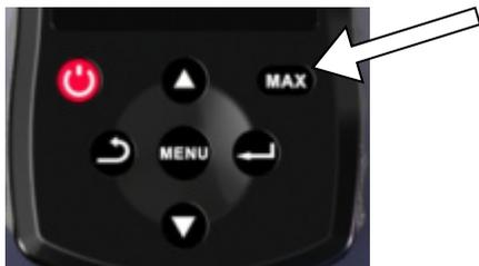
Il dispositivo misura 10 volte in 5 secondi e il valore massimo appare sullo schermo. Nel frattempo, i 10 registri sono memorizzati sulla scheda SD. Premere il pulsante MAX, mantenere il dispositivo fermo e non spostarlo. Inizia una misurazione automatica.
