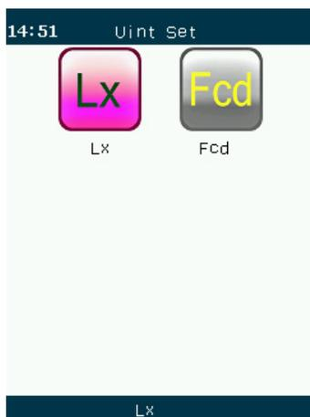
Nel misuratore cromatico PCE-CRM 40 ci sono due unità di illuminazione con le quali è possibile effettuare una misurazione: unità Lux (Lx) e Footcandles (Fcd).
