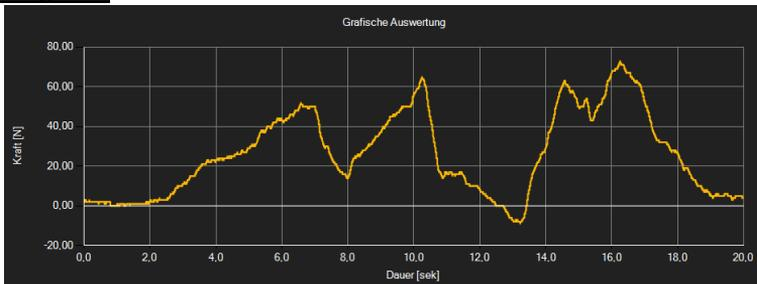
Nell'area di valutazione grafica, l'unità selezionata (forza o pressione) viene visualizzata sull'asse y e il lasso di tempo viene visualizzato sull'asse x. Quando si sposta il cursore sulla linea visualizzata, appare dopo un breve intervallo di tempo un quadro di informazione, mostrando i dati (ora e unità) del valore di misura attualmente selezionato. Questo grafico può essere selezionato facendo doppio clic su di esso.
