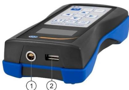
1. Connessione del sensore
