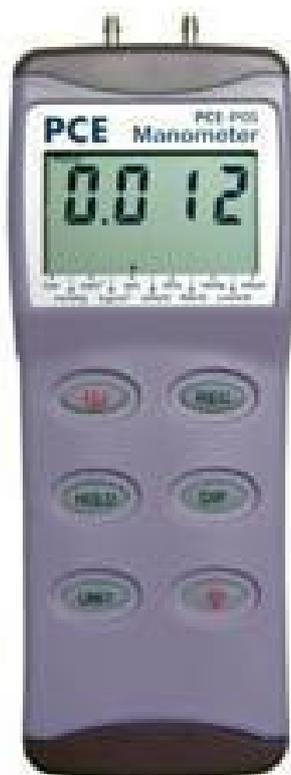
Con i manometri digitali PCE avrà la possibilità di misurare la differenza di pressione, ma non potrà misurare la pressione assoluta. I manometri si adeguano perfettamente ai settori del riscaldamento, ventilazione, aria condizionata, tecniche mediche e alle applicazioni nella neumatica e informatica.
