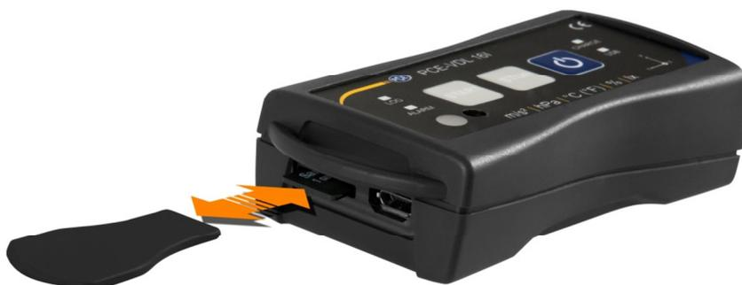
Per rimuovere la scheda MicroSD dal datalogger, inserire lo strumento di espulsione nello slot della scheda SD. La memory card esce dal supporto e viene rimossa dalla custodia. Per leggere i dati, inserire la scheda MicroSD in un PC, insieme al relativo adattatore.
