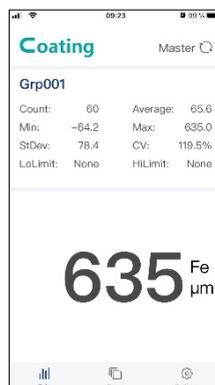
In "Gruppo" vengono visualizzati i dati di misura memorizzati nello strumento. Attraverso la funzione "Export" i dati possono essere salvati sul dispositivo mobile in formato CSV, PDF e anche come file TXT.
