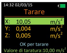
Collegare l'accelerometro al calibratore in modo tale che la vibrazione viaggi attraverso l'asse scelto dall'utente.
