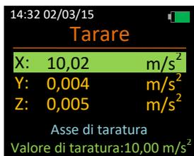
Se la taratura avviene con successo, verrà visualizzato Asse tarato in giallo per 5 secondi. In caso contrario verrà visualizzato Taratura non riuscita in rosso per 5 secondi.
