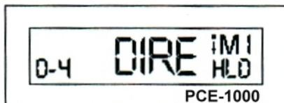
Premendo il tasto "M" potrà accedere al menù del tipo di materiale, con il tasto "C" potrà selezionare il tipo di materiale.
