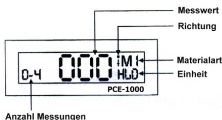
Nel PCE 1000 è possibile regolare la direzione della misurazione (DIRE), il materiale (MATE), la unità (CONV) e la formazione del valore medio (AVER). La immagine accanto mostra la configurazione del menù.
